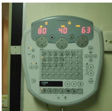
Gambar 4.3. Faktor eksposi saat pengujian
