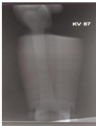
Gambar 4.5 Radiograf sampel 5 dengan kV 87
