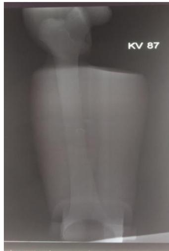
Gambar 4.8 Radiograf sampel 5 dengan kV 87
