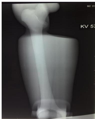
Gambar 4.2 Radiograf sampel 2 dengan kV 57
