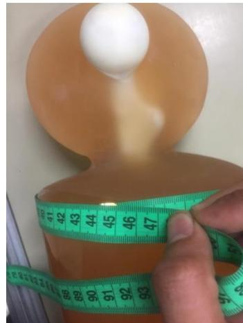
Gambar 4.3 pengukuran diameter phantom femur
