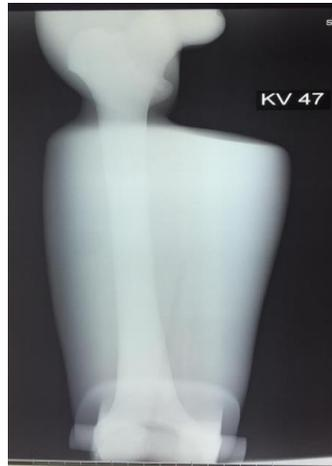
Gambar 4.1 Radiograf sampel 1 dengan kV 47
