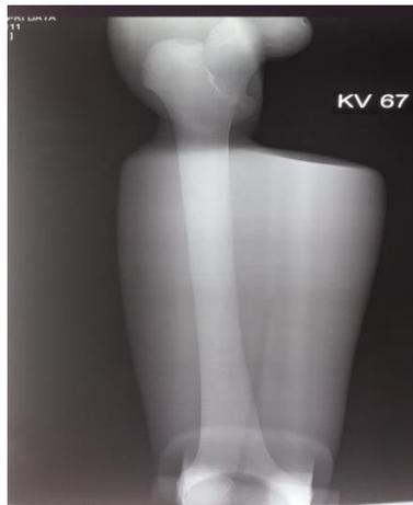
Gambar 4.6 Radiograf sampel 3 dengan kV 67
